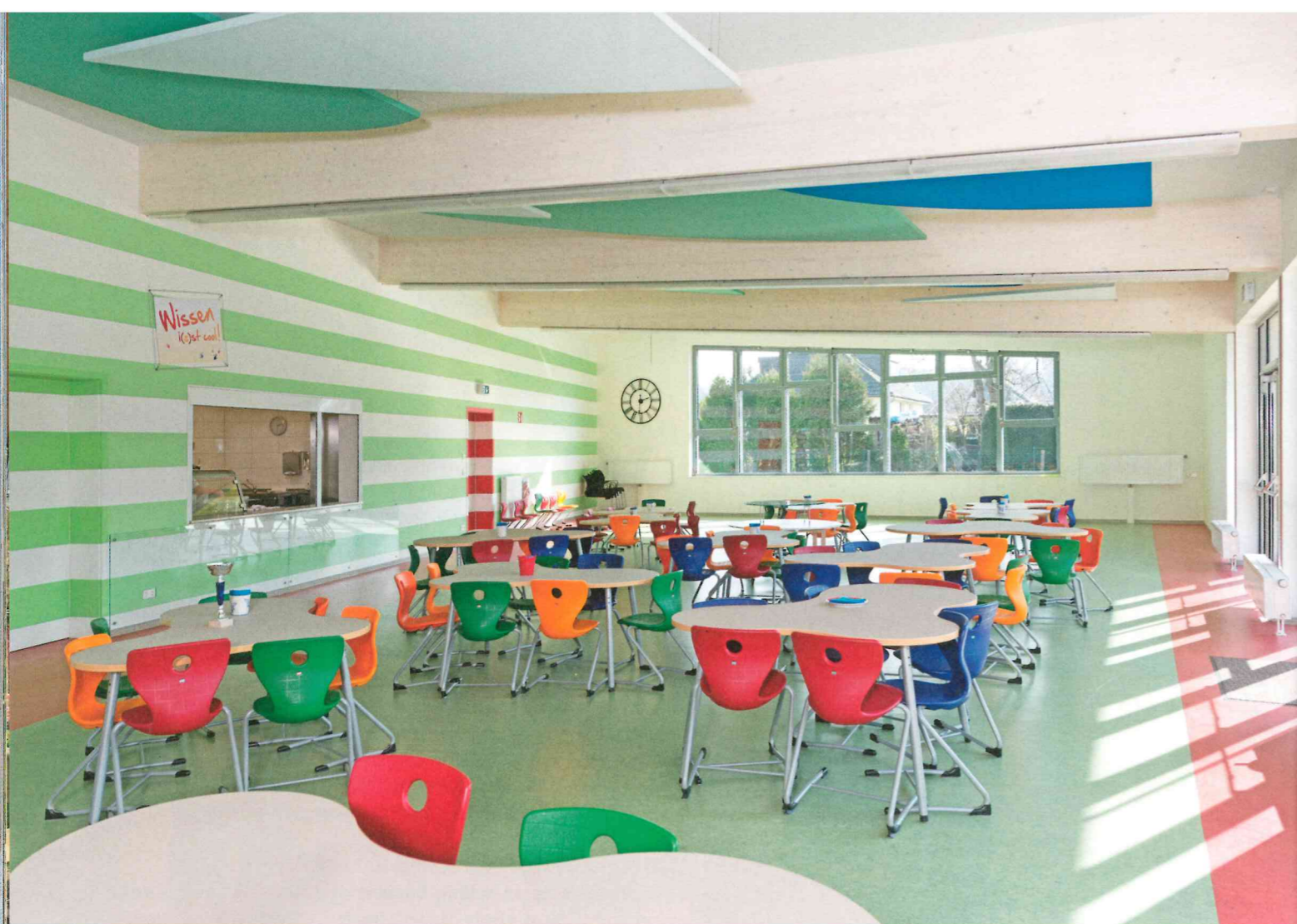
▲ Die Holzbauteile puffern die Feuchtigkeit im Raum und sorgen mit ihrem Wärmespeichervermögen für eine gleichmäßige Temperatur
