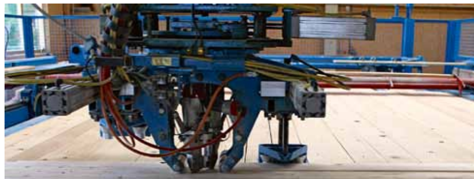
„Tack-tack-tack-tack“, tönt das Nagelaggregat des Wandmasters der Massiv-Holz-Mauer-Fertigungslinie, als er die genuteten Seitenbretter mit Aluminiumstiften fixiert
