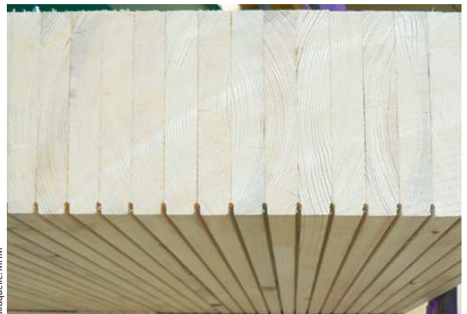
Die Profilholz-Elemente-Linie (PHE) verbindet 23 mm starkes Nadelholz zu Deckenelementen
