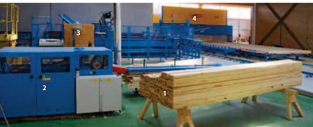
Kompaktes Layout bei Inholz: Die sägeraue und getrocknete Rohware (1) wird im ersten Schritt egalisiert und geriffelt (2). Der Wandmaster (3) erzeugt die Wandelemente. Die PBA (4) erledigt den Abbund
