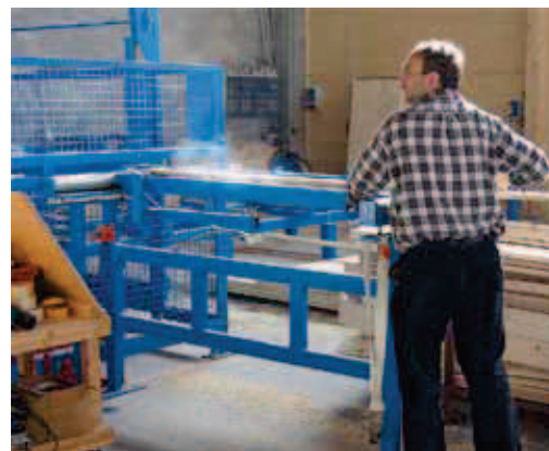
Aufgabe geschieht manuell: Ein Mitarbeiter schiebt Querlagenbretter in den Wandmaster
