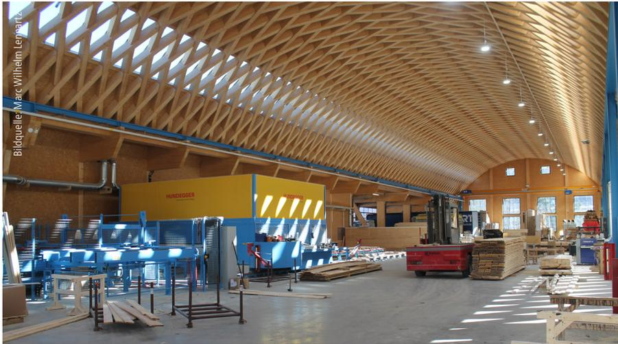
Die Zollingerhalle beherbergt die neue, vollautomatische Produktionsstraße zur seriellen Herstellung von leimfreien Kreuzlagenholz-Elementen aus sägerauen Brettern.
