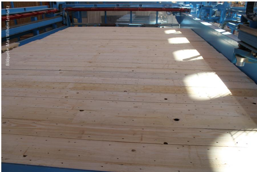
*Im Allgemeinen werden die massivhölzernen Wände wegen der Sichtbarkeit der in die Holzlagen eingeschossenen Alustifte innenseitig mit unterschiedlichen Bekleidungen oder Vorsatzschalen verhüllt. Es besteht die Möglichkeit einer rustikalen Sichtigkeit, da die tiefsitzenden Nägel keine Gefahr für anpatschende Kinderhände sind.*
