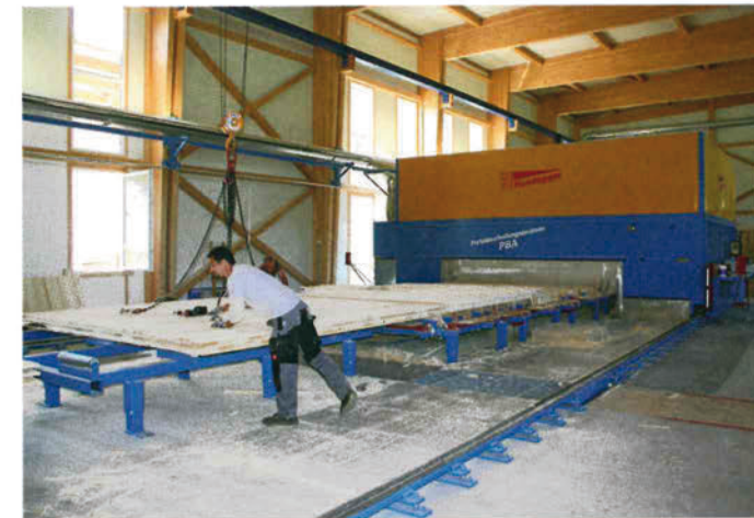
Die Hundegger-PBA ist dank Kreis- und Kettensäge, Falzautomat und Fräser ein richtiger Alleskönner
