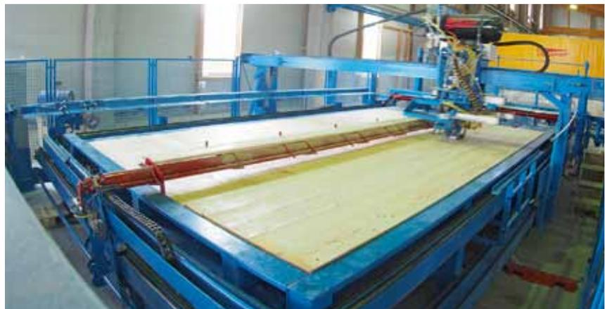
**Der automatische Wandmaster** befestigt gerade die zweite (waagrechte) Schicht auf der ersten – im Hintergrund wartet schon die PBA (gelb) auf den Abbund des Elements
