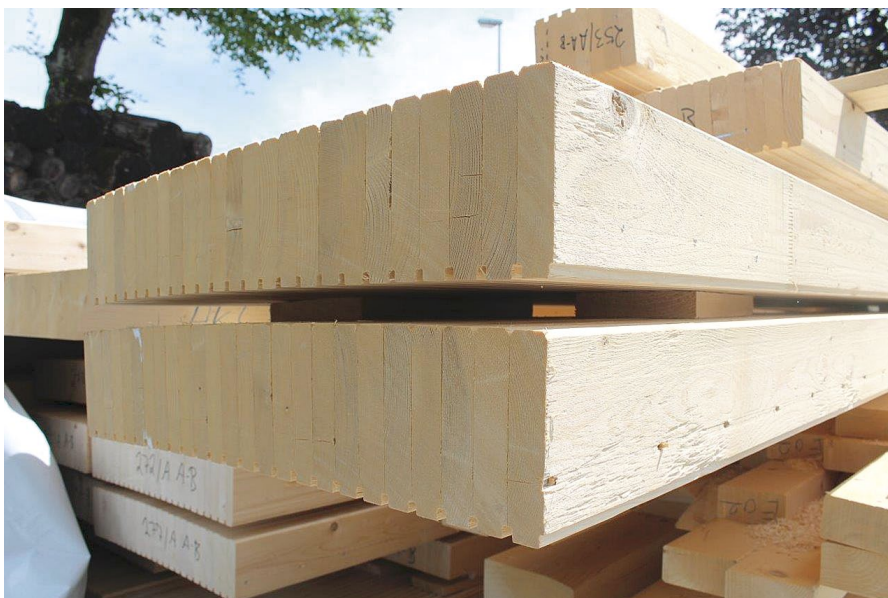
Die verbauten Brettstapelelemente sind rund 5 m lang und 60 cm breit. Zur Luftdichtung können sie nicht herangezogen werden.
