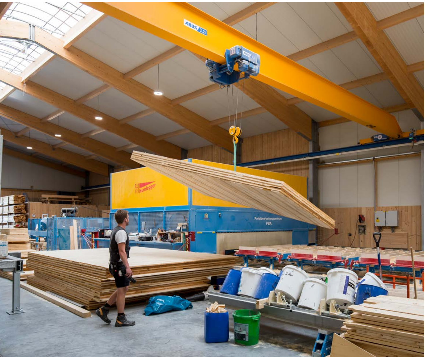
Transport eines Rohelements auf den Arbeitstisch der PBA
