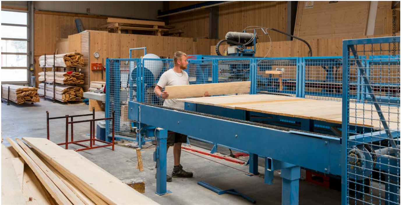
Fertigung eines Rohelements auf dem Wandmaster
